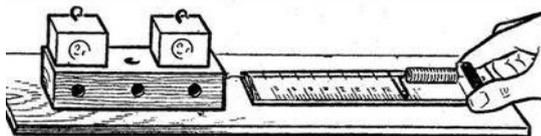
2. Сила трения измеряется при помощи динамометра. Сила нормальной реакции увеличивается при помощи грузов, которые помещаются на брусок.
